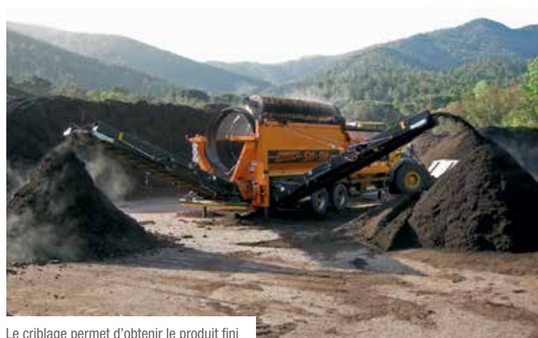
Le criblage permet d'obtenir le produit fini
