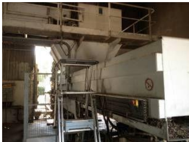
Le compacteur pour les OMR (photo de droite) et les caissons alimentés par ce dernier (photo de gauche)
